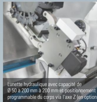
Lunette hydraulique avec capacité de Ø 50 à 200 mm à 200 mm et positionnement programmable du corps via l'axe Z (en option)
