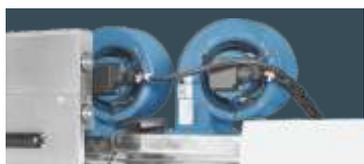
Ventilateurs de haute performance pour un meilleur contrôle de la température et pour éviter la dégradation de la matière
