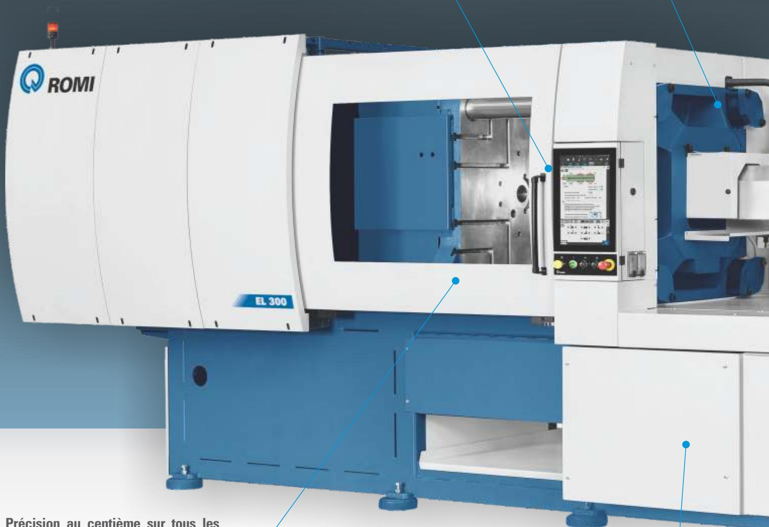
**Précision au centième sur tous les mouvements,** grâce à l'utilisation d'encodeurs optiques avec servo-moteurs et guidages par des glissières à billes.
