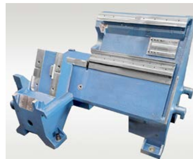
Structure monobloc en fonte de haute qualité
