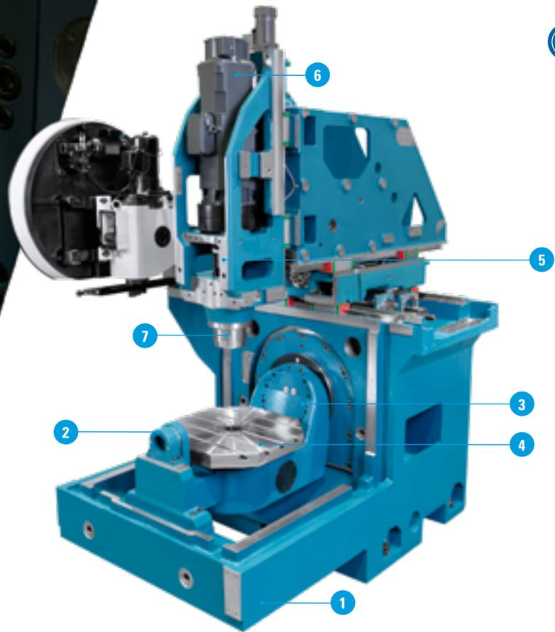
**1** **BATI** Il est en fonte, pour une grande stabilité. Il porte les tables, y compris les axes B et C, l'ensemble colonne et l'ensemble poupée fixe. Les axes X, Y et Z sont posés sur des guides linéaires à rouleaux qui apportent rigidité, stabilité, précision du positionnement et état de surface de haute qualité pour des processus d'usinage extrêmement efficaces et productifs.
